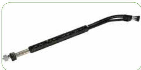
Flexibele kniklans met hogedruksproeier, 850 mm lengte, bij werkdruk ≤ 200 bar code: 1.208.828.xxxxxx
