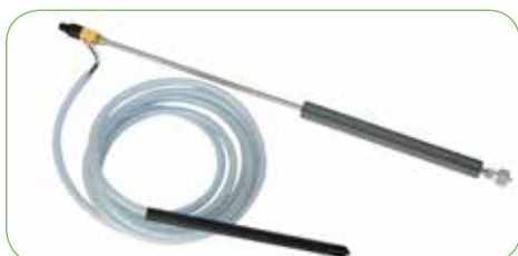
Gritstraallans van 900 mm met sproeier, snelkoppeling en aanzuigbuis, geschikt voor een werkdruk ≤ 250 bar code: 1.258.220.xxxxx
