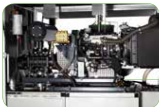
Industriële dieselmotor voor de aandrijving van de hogedrukpomp en het vacuümsysteem
