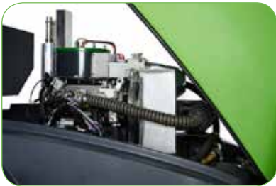
Warmtewisselaar voor motorkoeling met voorverwarming van het water uit de tank levert tot 15% brandstofbesparing
