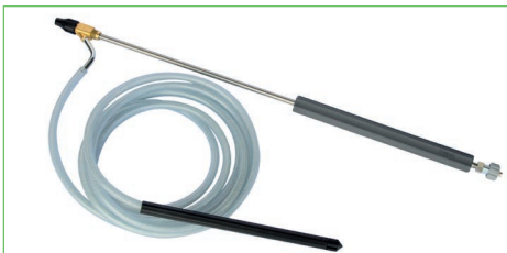
Gritstraallans van 900 mm met vlakstraalsproeier, snelkoppeling en aanzuigbuis, geschikt voor een werkdruk ≤ 250 bar, max. 40 l/min code: 1.258.220.xxxxx
