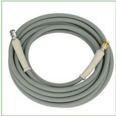
Hogedrukverlengslang met snelkoppelingen van 10 m tot 25 m en voor werkdrukken van ≤ 250 bar, ≤ 350 bar en ≤ 500 bar code : 1.208.520.xxx (≤ 250 bar) 1.208.540.xxx (≤ 350 bar) 1.208.560.xxx (≤ 500 bar)
